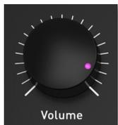
**Volume** regelt den Pegel des Audio-Ausgangs sowie des Kopfhörerausgangs. Der Audio-Ausgang liefert immer ein Signal mit Line-Pegel.
