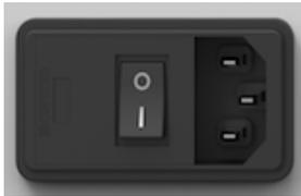
**!** Das kb37 verwendet ein internes Netzteil, welches zwischen 110 V und 220 V umgeschaltet werden kann. Stellen Sie sicher, dass die richtige Einstellung für Ihre Region ausgewählt ist, um Schäden zu vermeiden.
