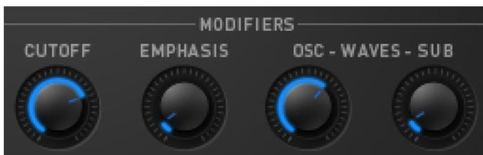
Diese Sektion beinhaltet die eigentliche Klangerzeugung. Zur Verfügung stehen zwei Wavetable-Oszillatoren (OSC und SUB) sowie ein resonanzfähiges 24dB Tiefpassfilter.
