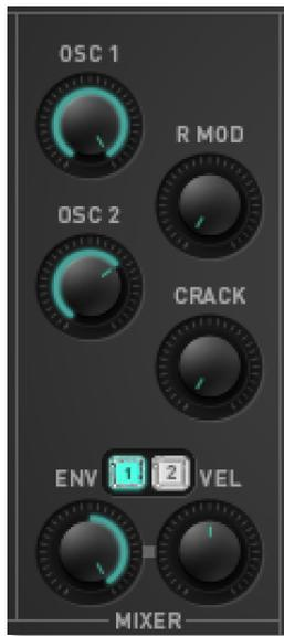
Im Mischer werden die Lautstärken der beiden Oszillatoren eingestellt. Ein Ringmodulator und die Crack-Modulation erweitern zusätzlich das Klangspektrum. Hier regeln Sie auch die Pegelsteuerung von Oszillator 2 durch die Hüllkurven und die Anschlagstärke.
