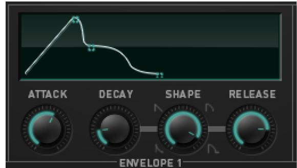
Durch Anschlagen einer Taste wird eine Hüllkurve gestartet. Die Hüllkurvenparameter haben die folgenden Funktionen:
