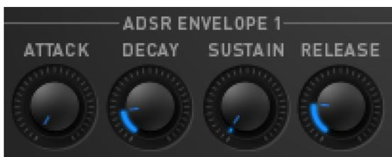
Eine Hüllkurve erzeugt ein zeitlich veränderliches Steuersignal. Sie wird verwendet, um beispielsweise den Filterverlauf eines Klages innerhalb eines bestimmten Zeitraumes zu modulieren. Die klassische Form der Hüllkurve besteht aus vier getrennt einstellbaren Phasen:
