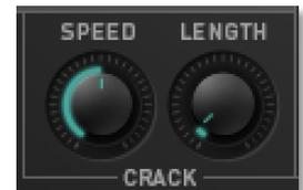
Beachten Sie, dass sich der Einsatz des Crack-Modulators auf die Summe aller anderen Mixer-Signale (Oszillator 1, 2 und Ringmodulator) auswirkt.
