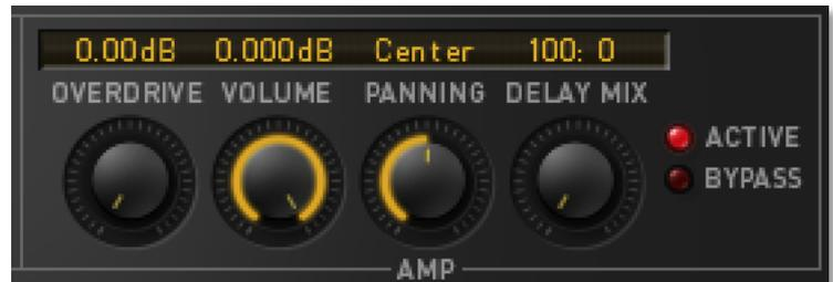
Darüber hinaus können Sie mit der Routing-Funktion („Active“ oder „Bypass“) wählen, ob Filter, Delay und Modulationen durchlaufen oder umgangen werden.
