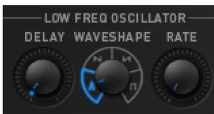
Ein LFO (Low Frequency Oscillator) ist ein Oszillator, der Schwingungen unterhalb der Hörschwelle erzeugt, die zur kontinuierlichen Steuerung unterschiedlicher Parameter verwendet werden können (beispielsweise für die WAVES, für das FILTER oder die Tonhöhe des Oszillators).
