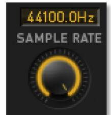
Normalerweise ist dieser Regler auf die aktuelle Samplerate eingestellt, denn so werden alle Samples des Eingangssignals an das Filter weitergegeben. Niedrigere Werte bewirken, dass nur jedes x-te Sample für eine bestimmte Dauer gehalten wird, bevor ein neues Sample aus dem Eingangssignal genommen wird. Dies hat den Effekt, dass das Filtersignal „trashy“ – also unsauber – klingt, wie bei den ersten Samplern, die Anfang der 80er Jahre ihren Siegeszug um die Welt antraten.
