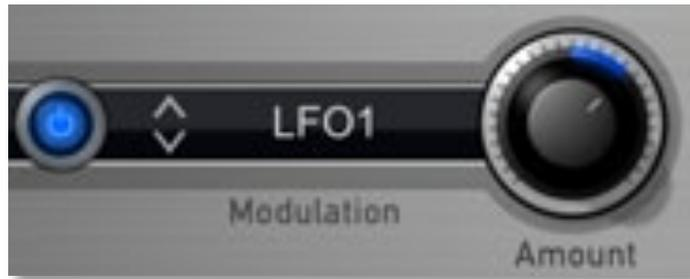
Aktivieren Sie diesen Parameter durch Antippen des Tasters. Wählen Sie dann durch Tippen auf die **Mod Source**-Liste die Quelle für die Pulsbreitenmodulation. Der **Amount**-Regler bestimmt den Einfluß der Modulation auf die Pulsbreite des Oszillators. Häufig verwendete Quellen für solche Modulationen sind Hüllkurven und LFOs, aber auch Aftertouch oder das Modulationsrad können sich gut für bestimmte Effekte eignen.
