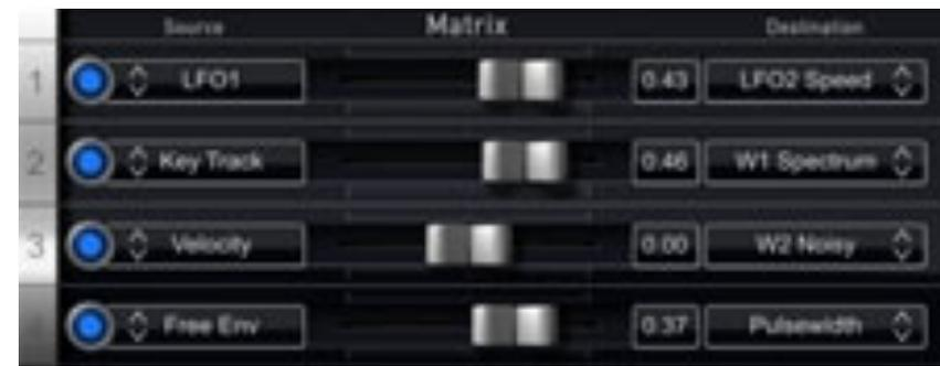
Eine Modulation kann als Beeinflussung eines Klangparameters durch eine Signalquelle beschrieben werden. Die hierbei verwendeten Parameter sind die Modulationsquelle (*Source*), das Modulationsziel (*Destination*) und die Modulationsstärke (*Amount*-Regler). Nave bietet 10 unabhängige Modulationszuordnungen (slots) mit jeweils individuell einstellbaren Parametern für Modulationsquelle, Modulationsstärke und Modulationsziel.
