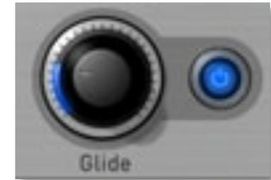
Dieser Parameter aktiviert und regelt die Glide-Funktion. Der Begriff „Glide“ oder „Portamento“ beschreibt das kontinuierliche Gleiten der Tonhöhe von einer Note zur nächsten, wie es bei Streichern und einigen Blasinstrumenten (z.B. Posaune) möglich ist. Dies ist ein typischer Synthesizer-Parameter und wird in fast allen Musikstilen benutzt. Beachten Sie, dass Glide die Tonhöhe aller Oszillatoren beeinflusst.
