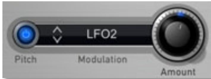
Bestimmt die Modulationsquelle für die Tonhöhenmodulation aller Oszillatoren. Aktivieren Sie diesen Parameter durch Antippen des Tasters. Wählen Sie dann durch Tippen auf die **Mod Source**-Liste die Quelle für die Tonhöhenmodulation. Der **Amount**-Regler bestimmt den Einfluß der Modulation auf die Tonhöhe der Oszillatoren. Eine übliche Modulationsquelle für die Tonhöhe ist beispielsweise ein LFO.
