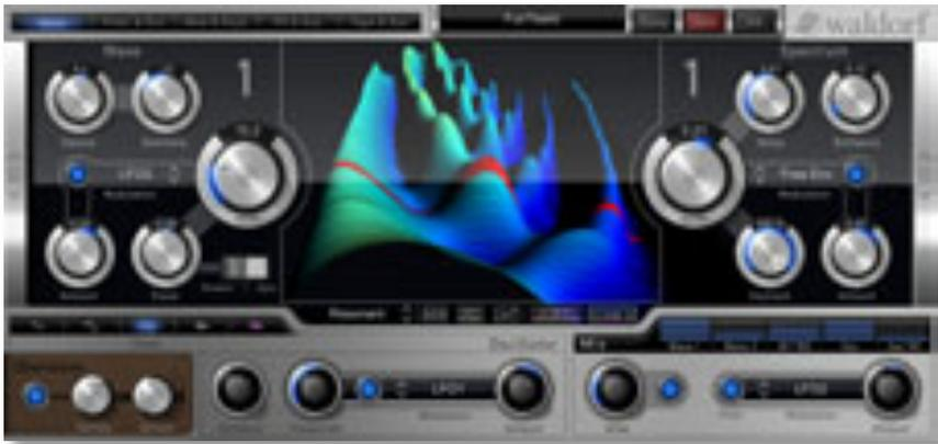
Nutzen Sie die beiden Schiebefelder rechts und links von der Wave-Menüseite, um zwischen Wave-Oszillator 1 oder 2 zu wechseln. Die Zahl oberhalb des Wave- bzw. Spectrum-Reglers zeigt an, welcher Wave-Oszillator gerade angewählt ist.
