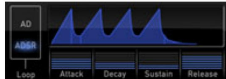
Filter- und Verstärker-Hüllkurve besitzen eine schaltbare Charakteristik für die einzelnen Phasen. Für **Sustain** gibt es diesen Parameter nicht, da dies keinen Sinn für einen Haltepegel machen würde.
